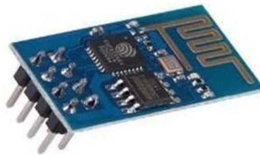
Fig.4. ESP8266 Wi-Fi module
