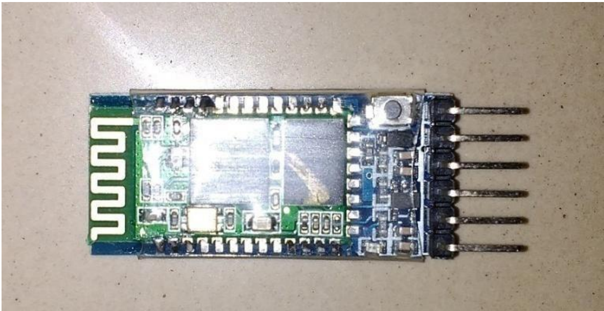
Fig: 8 Bluetooth modules used (JY-MCU Hc-05)
