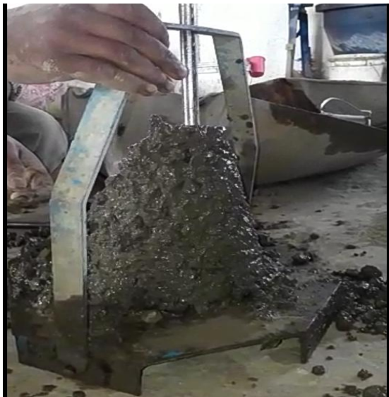
Fig.2. Slump cone test
